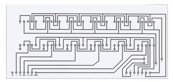
Ecco come viene il lavoro finito una volta saldati tutti i piedini. (non guardate troppo la pulizia visto che per semplicità ho usato la punta del saldatore per rimuovere la guaina dei cavi di collegamento)
